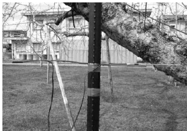
図4 TPE樹脂被服の汎用型センサー
