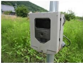
防犯カメラの設置
